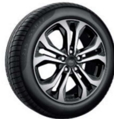
17" ελαφρού κράματος 5 ακτίνων με φινίρισμα Luster Nickel Βασικός εξοπλισμός στο ST-Line (με ελαστικά 205/45 R17)
