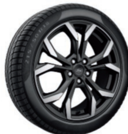
18" ελαφρού κράματος 8 ακτίνων με φινίρισμα μεταλλικό/ μαύρο ματ Βασικός εξοπλισμός στο ST-Line X (με ελαστικά 205/40 R18)
